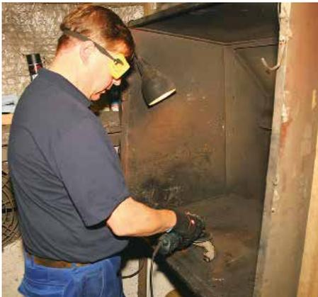
In einer Absaugkabine entfernt Schramm dann die überstehenden Kanten der Beläge mit einem Winkelschleifer
