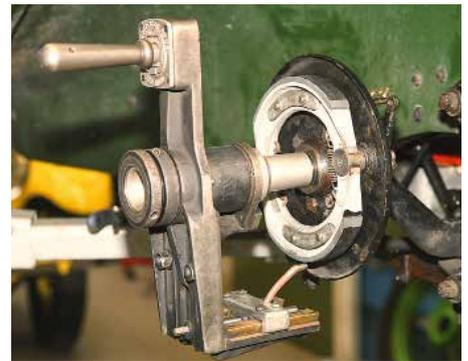
Fertig zum Kurbeln: Der Vorschub des Meißels erfolgt auf einem Schlitten automatisch bei jeder Umdrehung
