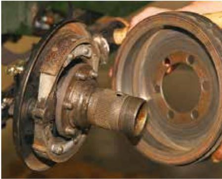
Die Achtzoll-Trommeln sind selbst für ein sehr leichtes Auto wie den MG J2 nicht gerade üppig dimensioniert. Der 500-Kilo-Roadster ist...
