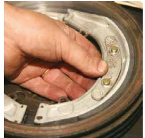
Erste Anprobe: Die Radien von Trommel und Reibbelag passen genau zueinander. Der letzte Schliff erfolgt am Fahrzeug
