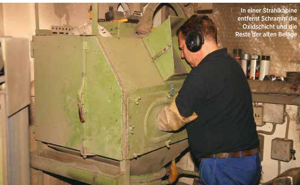
In einer Strahlkabine entfernt Schramm die Oxidschicht und die Reste der alten Beläge
