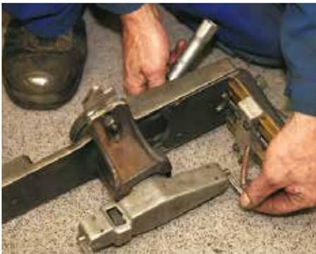
Über Langlöcher führt er den Schneidstahl an den Einstell-Taster heran, der dann einem Adapter weichen muss, der direkt auf den...
