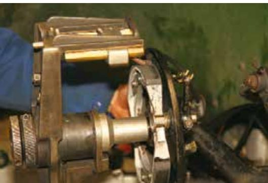
Beim Drehen entsteht eine Reibfläche, die auf die Radnabe zentriert ist und später genau an der kreisrunden Trommel anliegt
