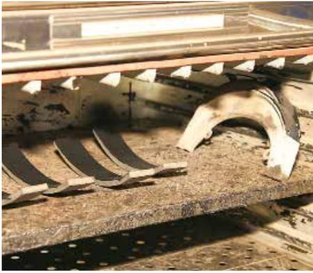
Das Ablüften lässt sich in einem Ofen deutlich beschleunigen. Nach der Wartezeit fügt Robert Schramm die Teile zusammen
