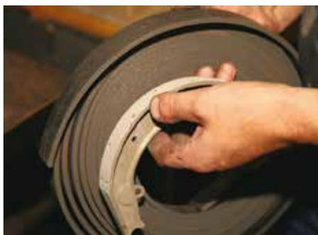
Die richtige Belagstärke ergibt sich aus der Differenz zwischen dem Innendurchmesser der ausgedrehten Trommel und dem...
