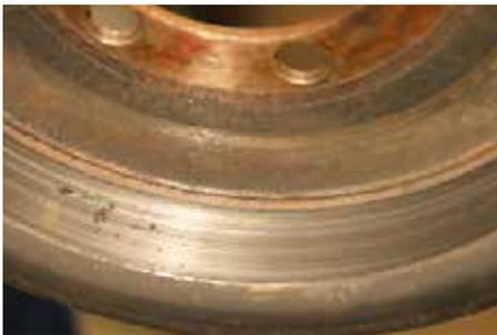
Das Innere der Trommel weist die typischen Riefen auf, die im Laufe der Jahre entstehen. Sie werden später beim Ausdrehen verschwinden
