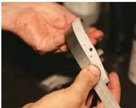
Mit einem biegsamen Stahlmaß ermittelt Schramm die notwendige Länge des neuen Belags und schneidet dann das Rohmaterial...
