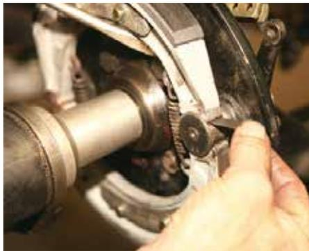
...Achsstumpf geschraubt wird. Damit später ein Luftspalt zwischen Belag und Trommel bleibt, sorgen dünne Blechstreifen für Abstand
