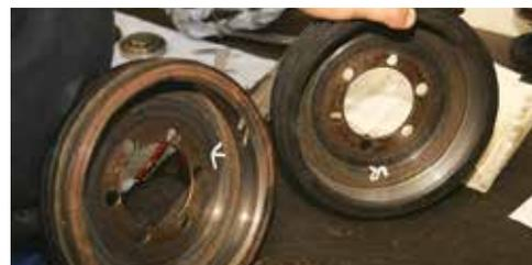
Auch eine eventuelle Unrundheiten verschwinden bei der Bearbeitung auf der Drehmaschine
