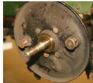
Die Bremsankerplatte darf nicht verzogen sein. Diese hier ist ist staubig – aber gerade
