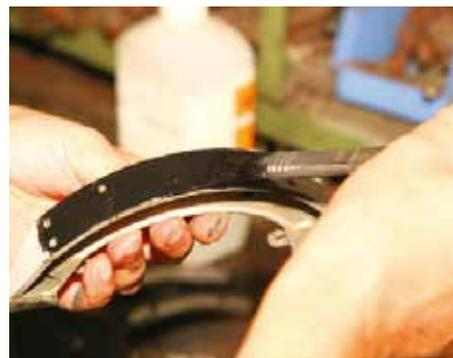
Dasselbe gilt für die Oberfläche der vier Belagträger. Der Kleber muss abtrocknen, ehe die Teile zusammengefügt werden können
