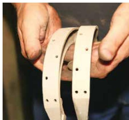
Nach dem Strahlen sehen die Träger aus wie neu. Die raue Oberfläche begünstigt eine feste Verbindung beim Aufkleben der Beläge
