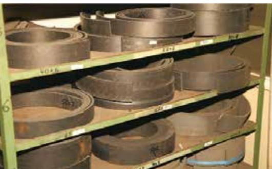
Rohmaterial in verschiedenen Stärken ist die Grundvoraussetzung für die Maßanfertigung der neuen Trommelbremsbeläge
