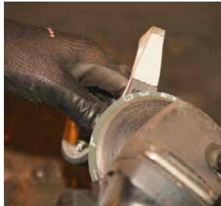
Besonders wichtig: Die auflaufende Seite des Belags muss angeschrägt werden. Sonst besteht die Gefahr, dass die Bremsbacke durch die...
