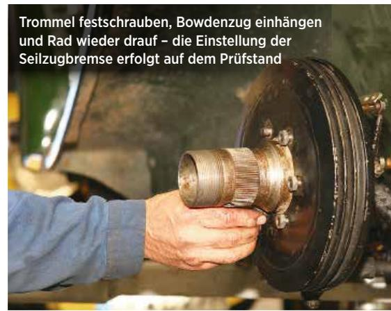
Trommel festschrauben, Bowdenzug einhängen und Rad wieder drauf – die Einstellung der Seilzugbremse erfolgt auf dem Prüfstand
