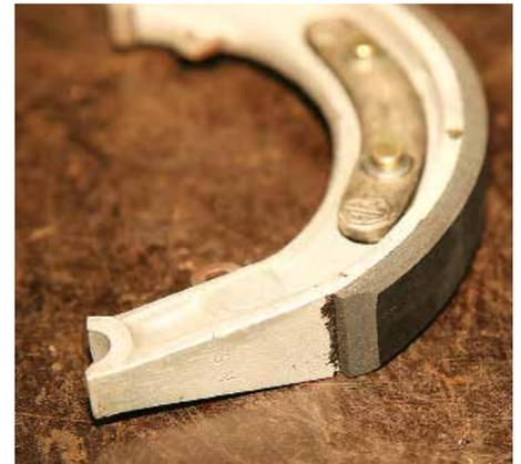
...drehende Trommel vom Nocken abgehoben wird. Im schlimmsten Fall kann die Bremsbremse dadurch sogar blockieren!
